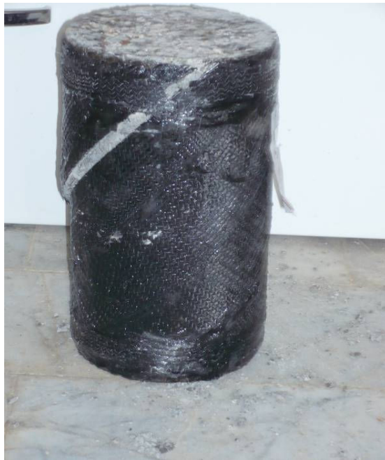
شکل 3. نمونه با نوارهایی با زاویه 45°
