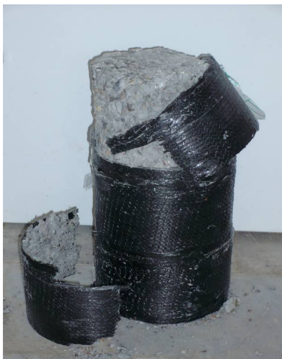
شکل 2. نمونه با نوارهایی با زاویه 90^\circ
